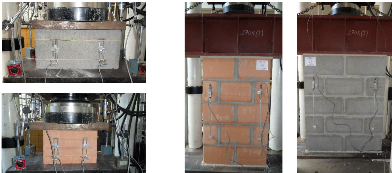
Figura 1 – Ensaio de caracterização dos materiais e da alvenaria.
