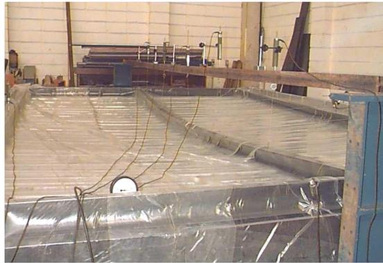
Figura 3 – Ensaio do sistema terça-telha em caixa de sucção. (Fonte: Javaroni (1999)).
