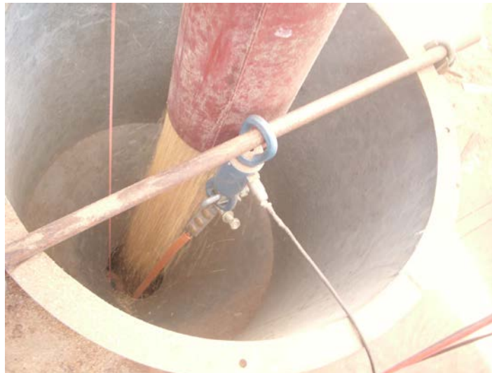
Figura 1 – Célula de carga fixada ao cabo de termometria.
