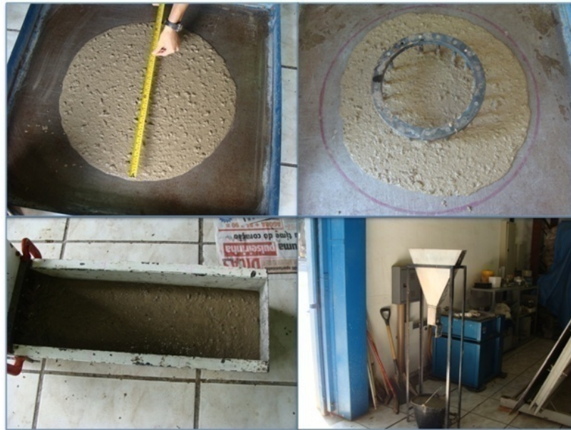
Figura 6 – Ensaio de caracterização do concreto fresco. (PEREIRA, 2010).
