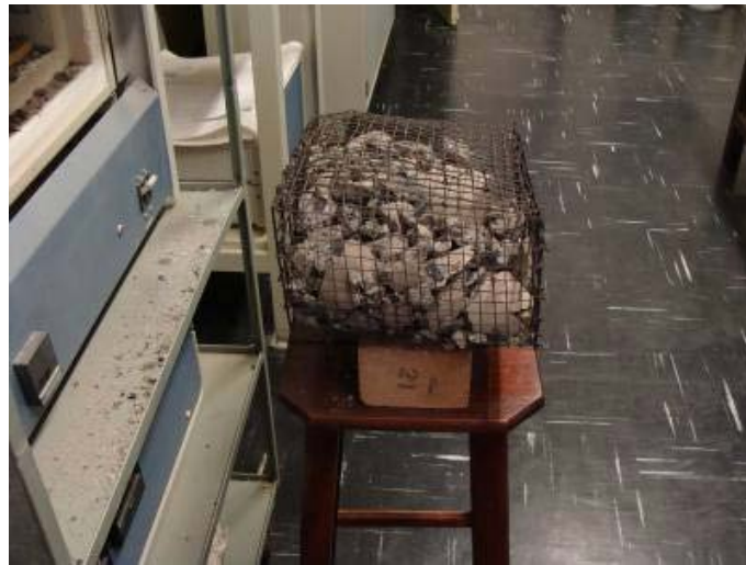
Figura 8 – Concreto com adição de lã-de-rocha após ser submetido à temperatura de 400°C. (PEREIRA, 2010).
