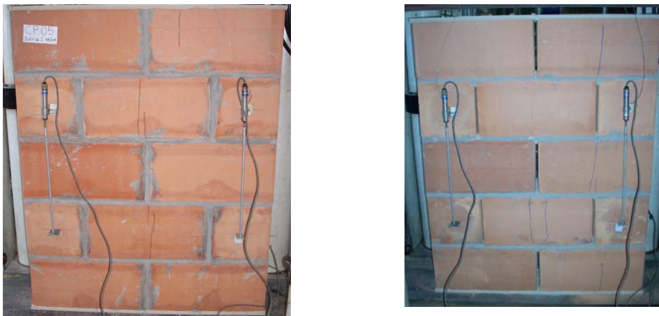
Figura 9 – Modo de ruptura das pequenas paredes das 1ª e 2ª séries.
