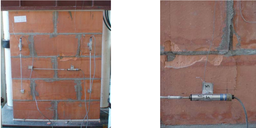
Figura 13 – Modo de ruptura das pequenas paredes da 3ª série
