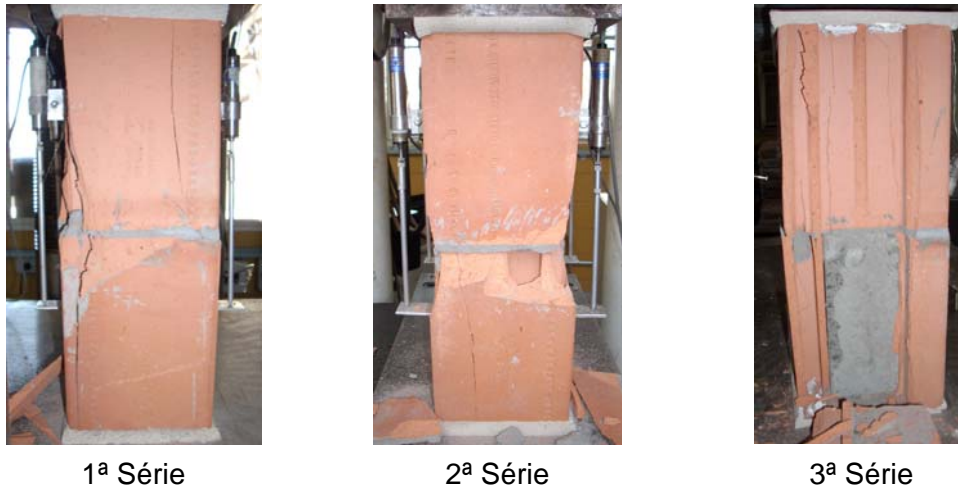
Figura 8 – Modo de ruptura dos prismas das 1ª, 2ª e 3ª séries.
