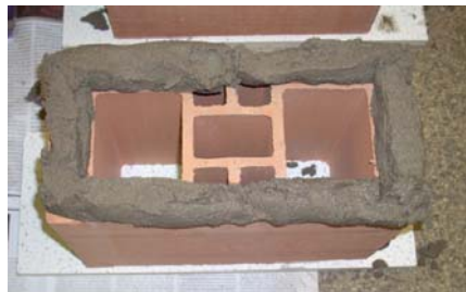
Figura 4 – Assentamento dos prismas grauteados no estudo preliminar.
