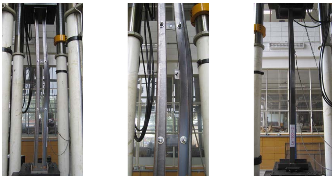
Figura 12 – Instabilidade por flexo-torção (FT)/flexão em relação ao eixo de menor inércia do conjunto (F)/flexão em relação ao eixo paralelo à aba conectada ( F^* ) ( L_c = 1800 mm – Compressão excêntrica).
