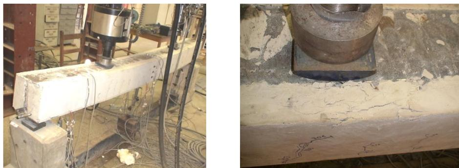
Figura 6 – Aspecto final das vigas mistas parcialmente revestidas ensaiadas.
