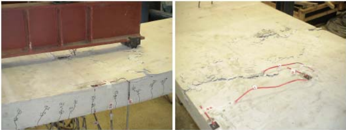
Figura 6 – Aspecto final e modo de ruptura nas vigas mistas ensaiadas.
