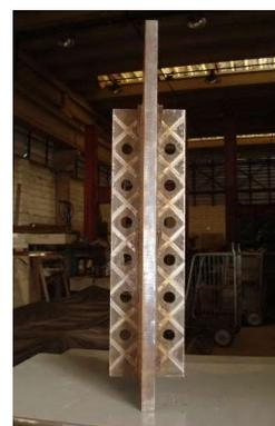
Figura 7 – F ormas do conector RP Push-out: a) Dimens es em mm; b) Conector RP + Placa de rea o
