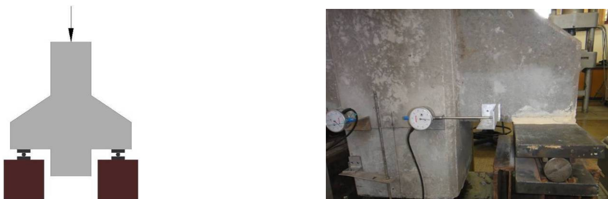
Figura 3 – Esquema de ensaio dos modelos e detalhe do apoio.
