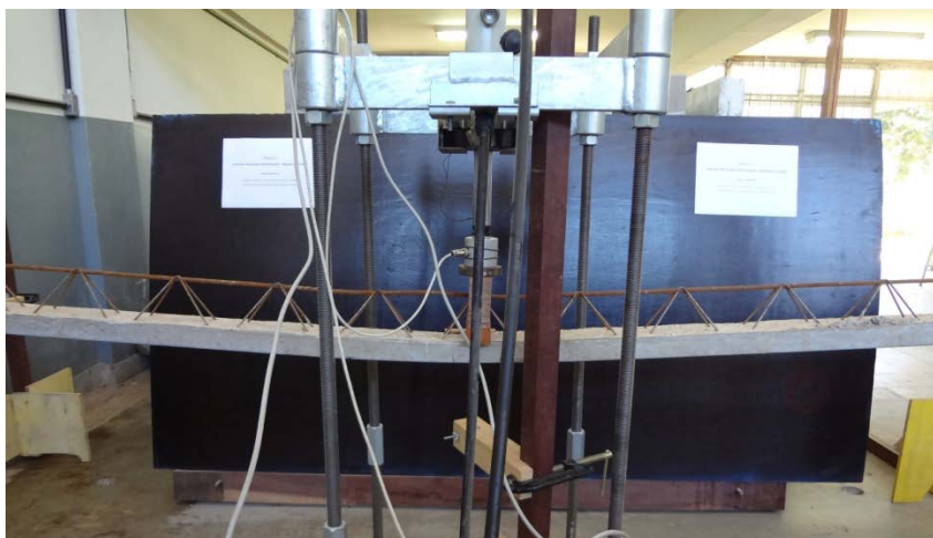
Figura 3 – Flecha acentuada observada na vigota V6 durante o ensaio.
