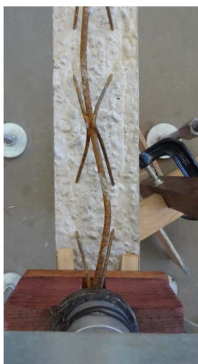
Figura 4 – Flambagem do banzo superior da Viga V3-TR 10745 e 1 fio de protensão de 5mm.
