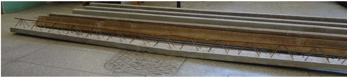
Figura 10 – Deformação residual da vigota V6 TR 12845 (1 fio de protensão) após o ensaio.
