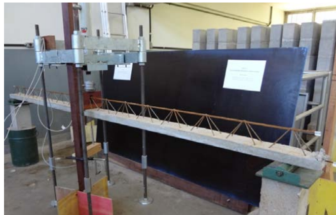
Figura 1 – Viga V1 biapoiada sob ação de força concentrada no meio do vão e transdutor de deslocamento para leitura da flecha.
