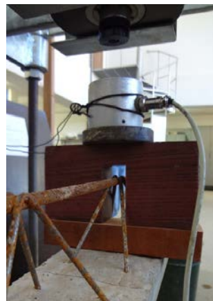
Figura 2 – Detalhe do ponto de aplicação da força concentrada no meio do vão por meio de aparato de madeira com apoio da célula de carga.
