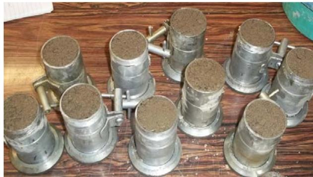
Figura 2 – Moldagem de corpos-de-prova cilíndricos (5 cm x 10 cm) (Fonte: Autor).
