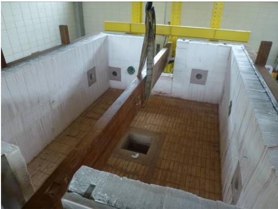
Figura 1 - Forno para realização de ensaios em temperaturas elevadas.
