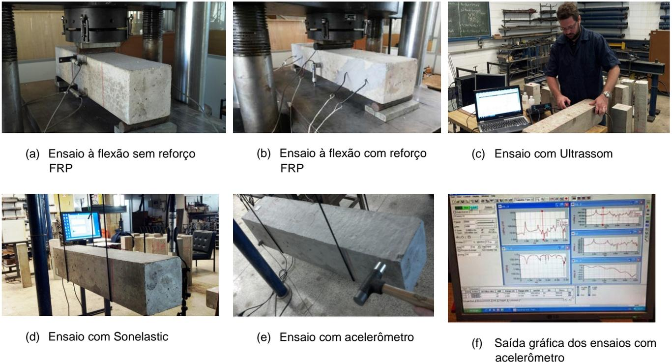
Figura 2 – Esquemas de ensaios dos prismas.
