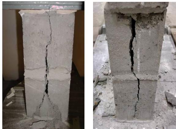
Figura 12 – Forma de ruptura dos PR2B e PR3B.
