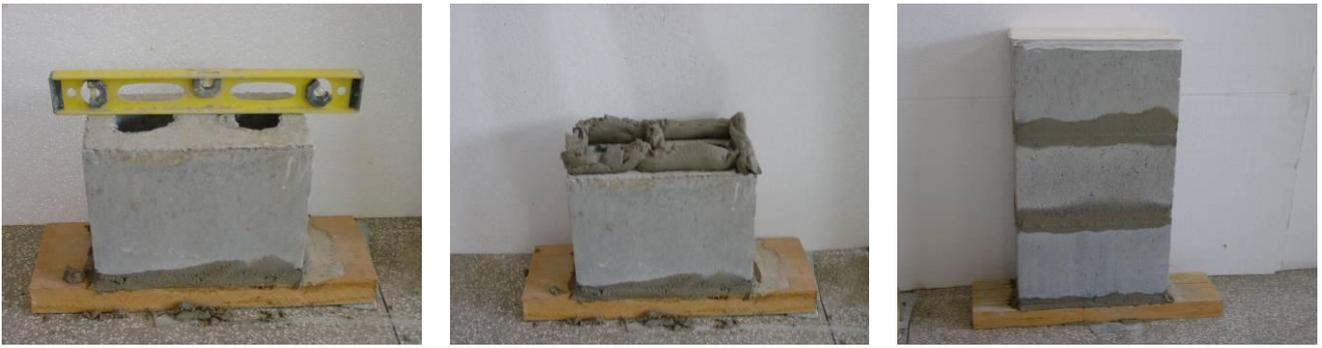
Figura 6 – Montagem dos corpos de prova.
