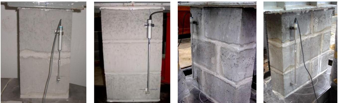
Figura 8 – Instrumentação dos PR2B, PR3B, PRC1½B e PRC2B respectivamente.
