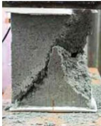
Figura 9 – Modo de ruptura dos blocos de concreto.
