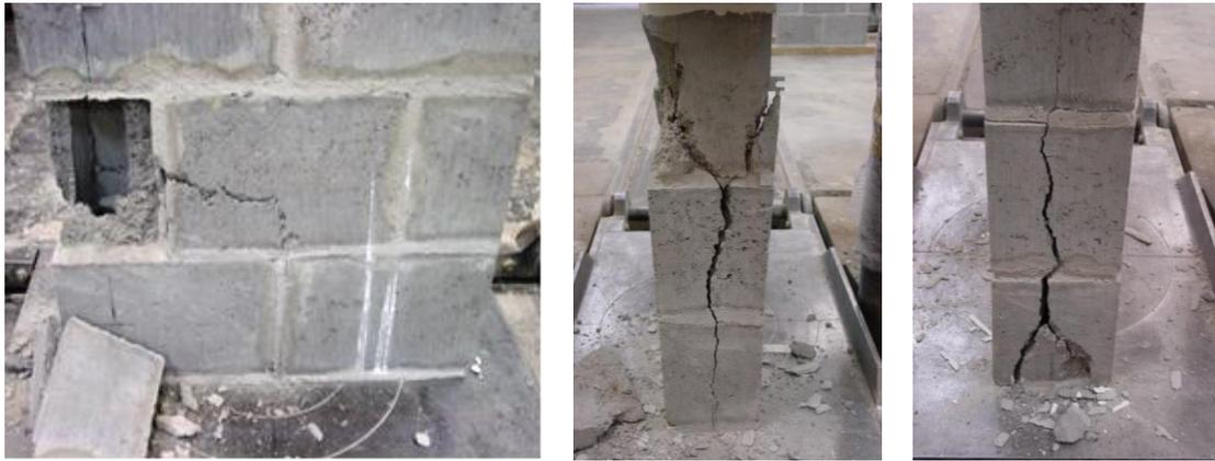
Figura 14 – Forma de ruptura dos PRC2B.
