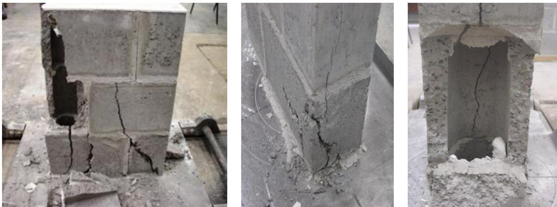
Figura 13 – Forma de ruptura dos PRC1½B.
