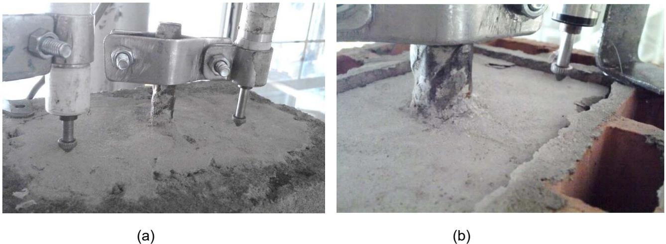
Figura 10 – Posição do graute depois de ensaiados os corpos de prova de blocos de concreto sem escorregamento do graute (a) e blocos cerâmicos com escorregamento do graute (b)
