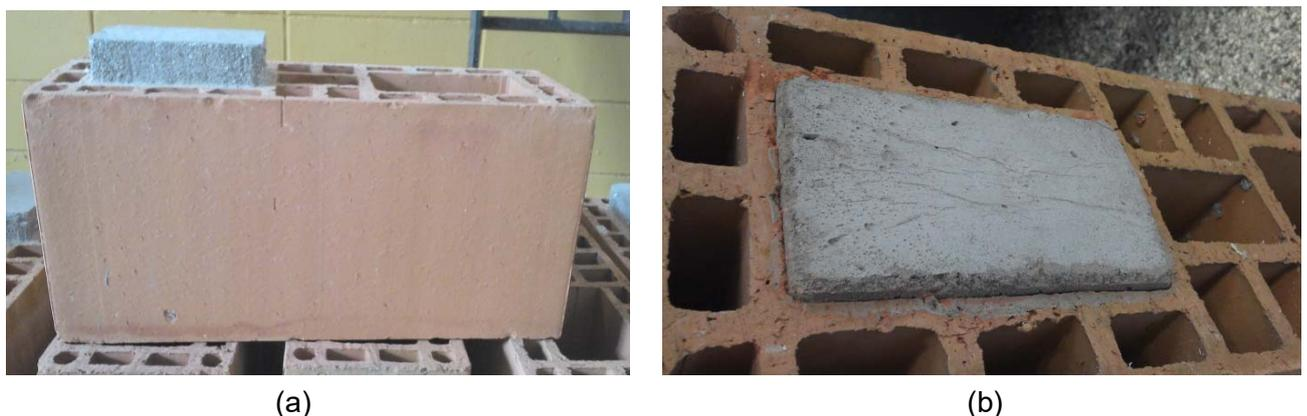
Figura 7 – Ruptura típica do ensaio de “push-out” para os blocos cerâmicos antes (a) e depois (b) do ensaio
