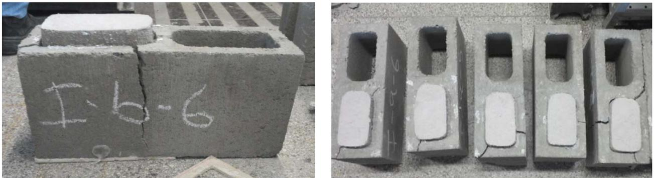
Figura 6 – Ruptura típica do ensaio de “push-out” para os blocos de concreto
