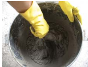
Figura 7 – Argamassa com fibras PP1.
