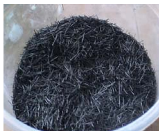
Figura 5 – Fibra Concretil da Orpec (PP2).
