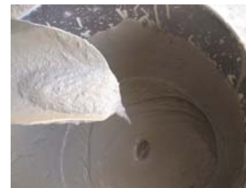
Figura 8 – Argamassa com fibras PP2.
