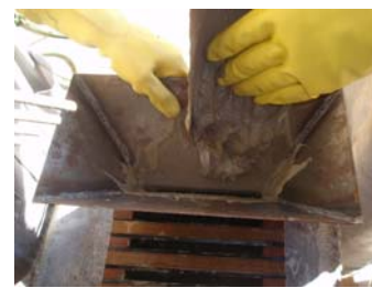
Figura 6 – Preenchimento das formas.
