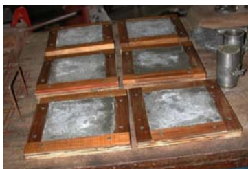
Figura 1 – Placas moldadas em formas sem controle de uma das superfícies.
