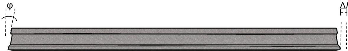
Figura 4 – Ilustração da rotação ( $\varphi$ ) e deslocamento axial ( $\Delta l$ ) que aparecem nos extremos da viga.
