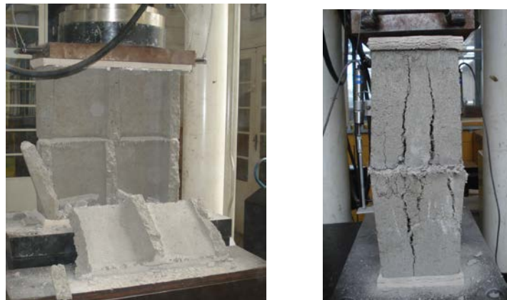
(a) Ruptura frágil dos prismas sem reforço
