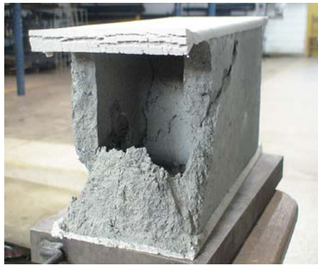
Figura 5 – Ruptura frágil dos blocos sem adição de fibras.
