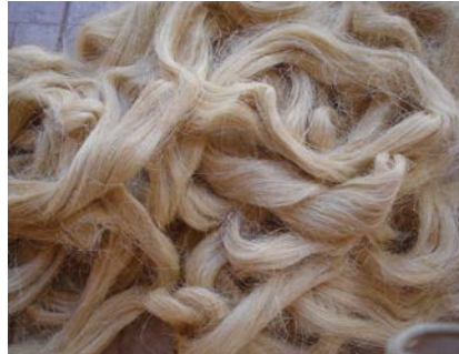
Figura 1 – Fibra de sisal Tipo 3 com tratamento à base de óleo mineral.
