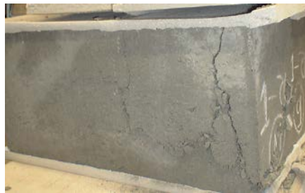
Figura 6 – Ruptura dúctil dos blocos com adição de fibras.
