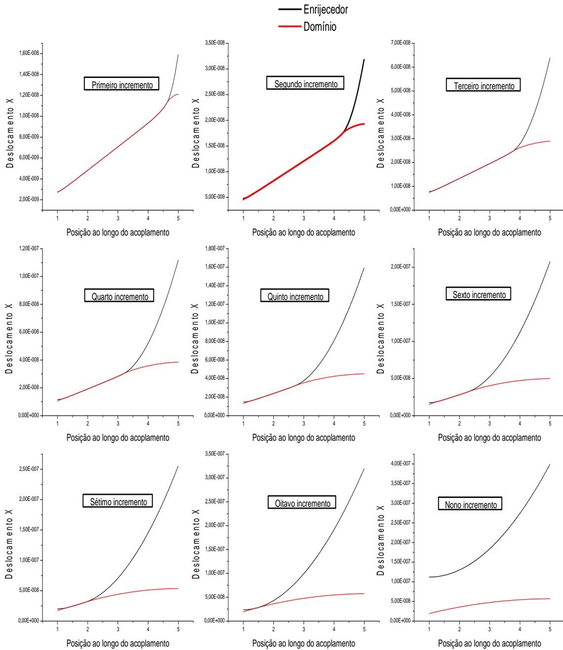
Figura 7 – Gráfico da evolução do desacoplamento dos deslocamentos do domínio e do enrijecedor.
