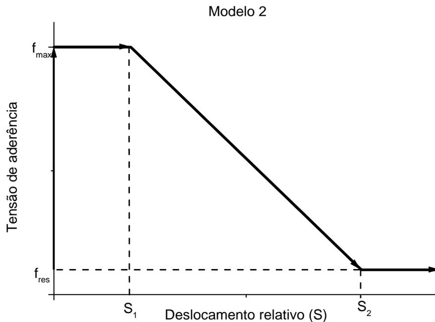
Figura 3 – Gráfico da tensão de aderência pelo deslocamento relativo (S) – MODELO 2.
