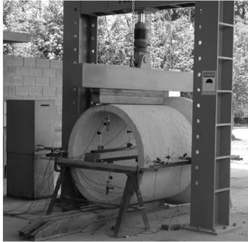
Figura 2 – Pórtico metálico usado nos ensaios de compressão diametral.
