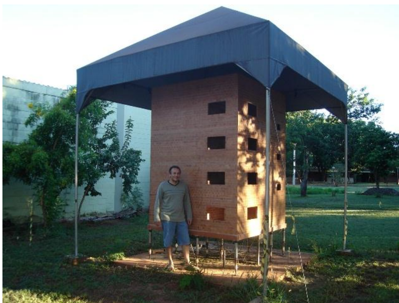
Figura 3 – Ilustração do modelo físico reduzido (1:5).
