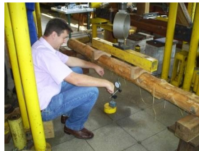
Figura 2 – Esquema estático do ensaio de peça roliça de madeira estrutural. Fonte: Foto do Autor, ensaios realizados no LaMEM em 2008.
