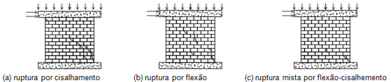
Figura 3 – Modos de ruptura de painéis.
